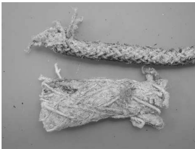
Asbestschnüre. Verwendung zur Abdichtung an brandgefährlichen Stellen, Foto IST
