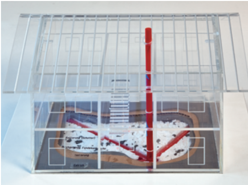
Modell: Unterbodenabsaugung, Abluft über Dach (Vollwandrohr mit einem Durchmesser von mindestens 15 cm)
