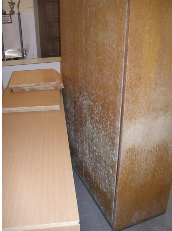
Schimmelbefallene Rückwand eines Schrankteiles, Reinigung unwirtschaftlich
